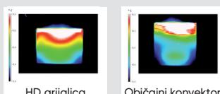
HD toplinska difuzija grijajuće ploče u usporedbi s klasičnim konvektorom
